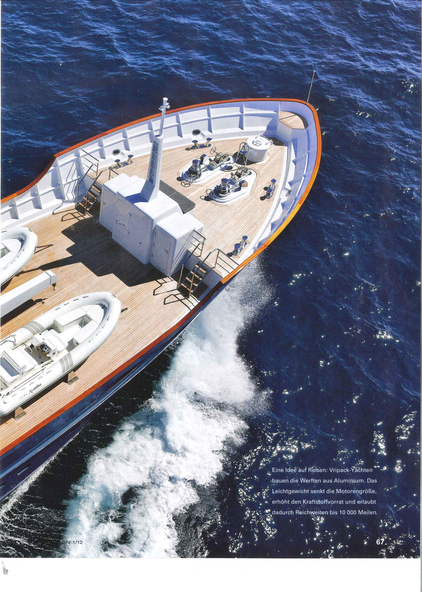
Eine Idee auf Reisen: Vripack-Yachten bauen die Werften aus Aluminium. Das Leichtgewicht senkt die Motorengröße, erhöht den Kraftstoffvorrat und erlaubt dadurch Reichweiten bis 10 000 Meilen.
