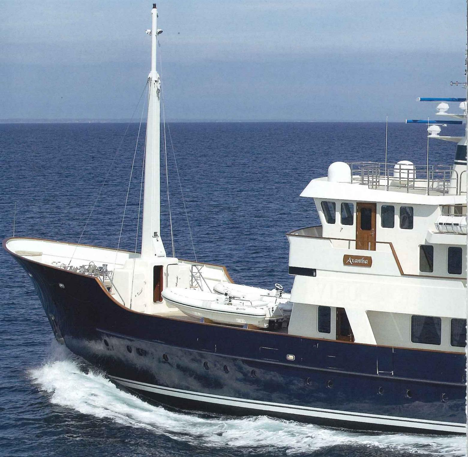
Konservative Linien, übersichtliche Decks, überzeugende Leistung: Mit gut 40 000 Litern reist „Axantha“ 4000 Meilen nonstop. Den Kran für die beiden Tender auf dem Hauptdeck versteckten die Konstrukteure
