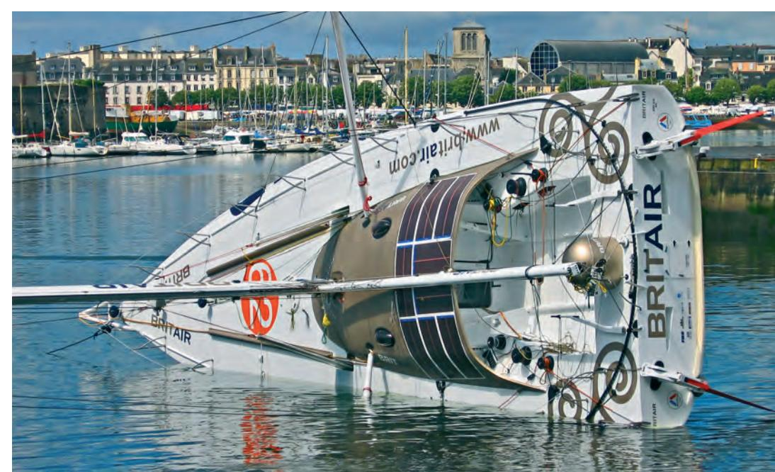
Test à 90° de Britair devant le chantier JFA. Britair 90° test along side JFA dock.
